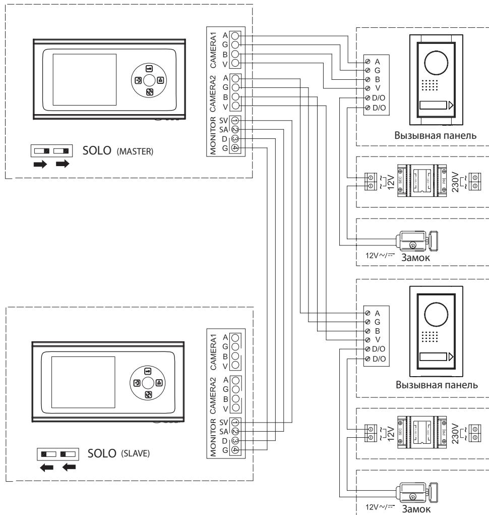
Схема подключения двух вызывных панелей и двух замков
